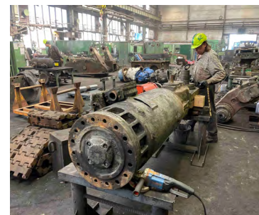
Práce na opravě převodovky rezného orgánu.
